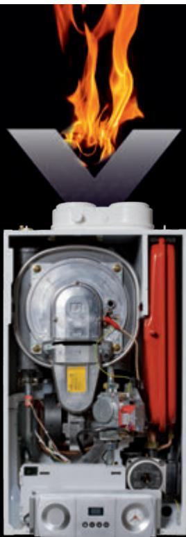
Caldaie murali a gas a condensazione a metano, con possibilità di conversione a GPL e aria propanata. Rendimento annuale fino al 109%. Emissioni molto ridotte di agenti inquinanti. Scambiatore di calore in acciaio inox AISI 316 L, bruciatore gas a premiscelazione totale. Campo di modulazione potenza da 20 a 100%. Dimensioni 740x400x300 mm.
